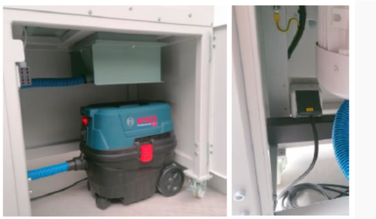
Figura 1. Aspiradora opcional con fuente de alimentación conmutada en la máquina de shredding
